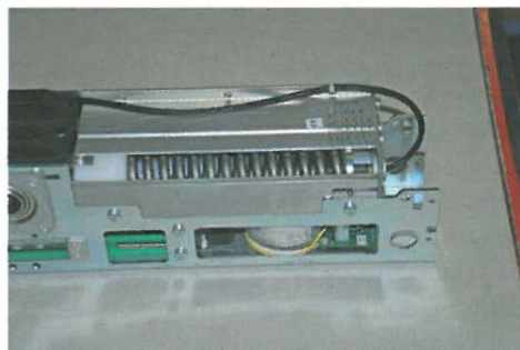
Dettaglio della molla di richiamo per l'apertura e la chiusura della porta senza corrente.
