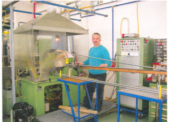
Normalerweise werden Gewindespindeln als 3-Meter-Stangen gefertigt, Längen bis 6 m sind aber möglich.
