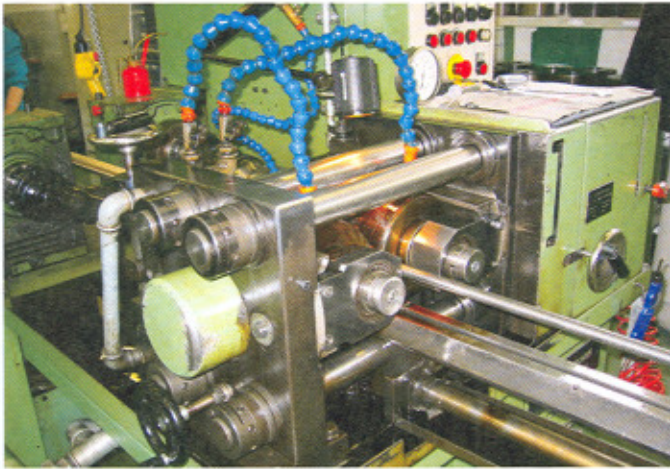
Im sogenannten Durchlaufverfahren werden die Gewinderollen gegenläufig schräggestellt, der rotierende Rohling läuft in der Folge kontinuierlich durch die Maschine hindurch.
