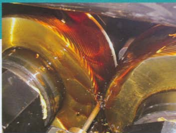
Procedimento di rullatura di una barra di minuscole dimensioni. Ad oggi, Eichenberger è leader nell'ambito della produzione di viti a ricircolo di sfere rullate, disponibili in svariate e minuscole dimensioni
